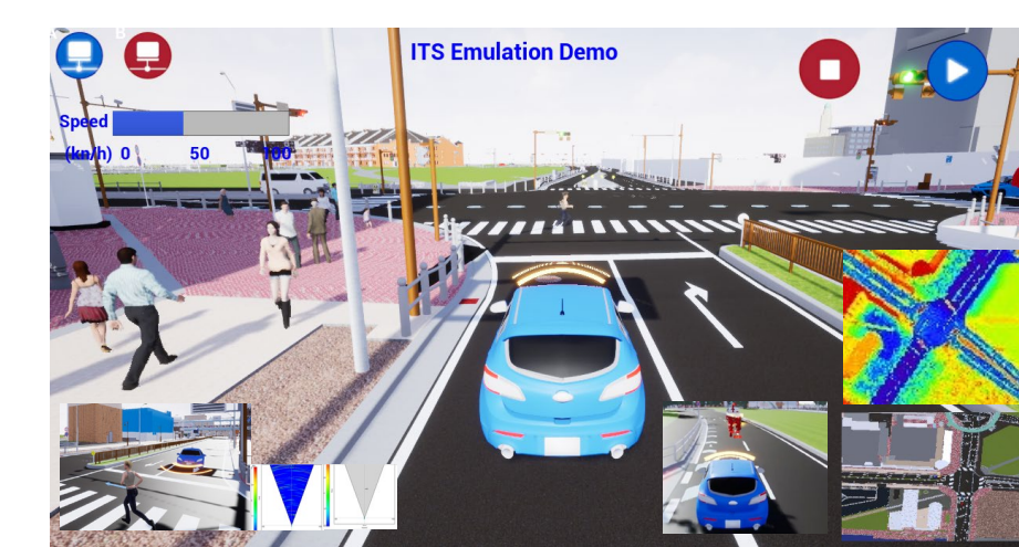
図3. ITSエミュレータのインタフェースのイメージ 子画面として 路側カメラ映像、レーダ検出結果、近傍の電波伝搬可視化、俯瞰図等を表示
